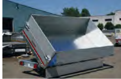
Abb. Oben scharnierverschlossene Bordwände
