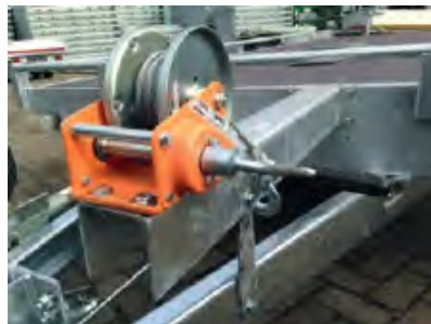
Fig. Spil Kabelspil T1-208
